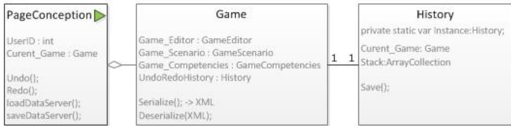
Fig 18 : Diagramme de classes pour les fonctionnalités de Undo Redo
